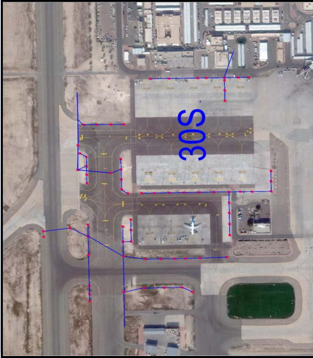
مخطط 4: شبكة صرف مياه الأمطار لمواقف الثلاثينات
