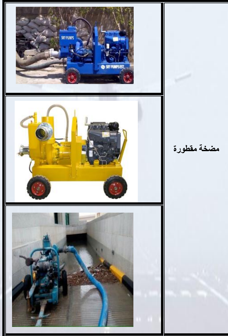
جدول (3): صور توضح شكل المضخة المقطورة.
